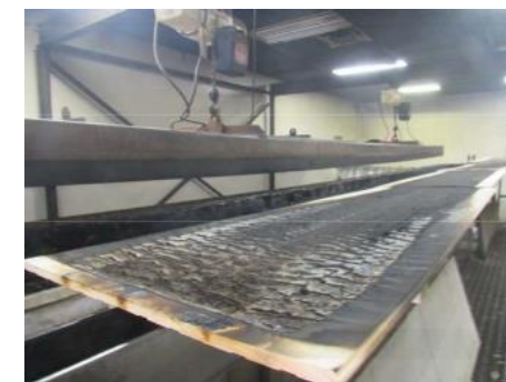
Sau đợt thử nghiệm / thử nghiệm tra Hinoki 15mm Ngày 7 tháng 2 năm 2022 Intertek
